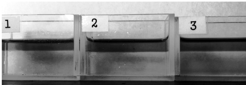
Рис.6. Расслоение при – 20 °С водного раствора и окрашенного анализата (йода), экстрагент: 1) ацетонитрил; 2) смесь ацетонитрила с этилацетатом (85:15); 3) смесь ацетонитрила с этилацетатом и изопропанолом (80:15:5).
