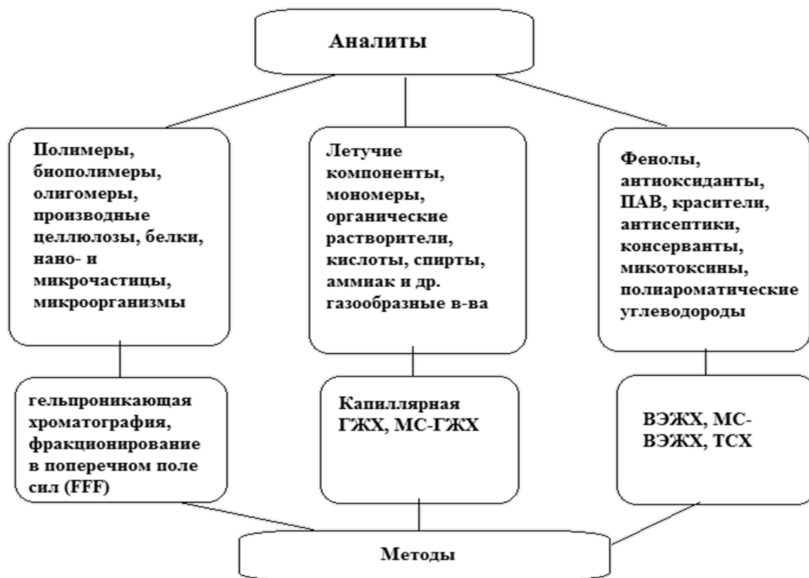
Рис. 5. Хроматографические методы контроля СМ и аналиты, определяемые этими методами
