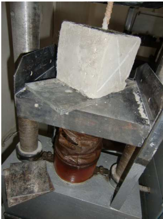
Рис. 1. Фото испытаний прочности сцепления фибропенобетона со стеклопластиковой арматурой периодического профиля
